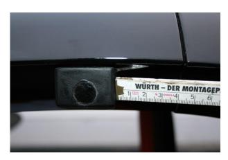
Metallgegenplättchen für bessere Anzugskraft an der Position der Magnete unter das auf die Scheibe aufgesteckte Metallklammerprofil einschieben. Beachten dass der Scheibenmagnet ganzflächig aufliegt.
