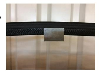
Falls erforderlich die Scheibe durch seitliches Verschieben in der Aluführungsschiene in die endgültige Position bringen.
