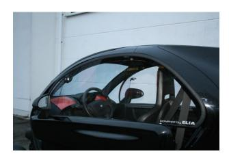
Schloss verriegeln, von innen pro Seite 5 Schrauben mit Gefühl montieren, um überdrehen zu verhindern und den Moosgummi nicht zu dünn zu pressen, sodass noch leichte Federwirkung bleibt.
