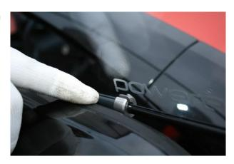
Zum Schutz vor Laufspuren transparenten halbmondförmigen Aufkleber von innen an der Laufbahn der Verriegelung auf die original Dreiecksscheiben aufkleben.
